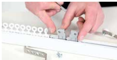
Étape 2 : On rapproche les 2 demi-conducteurs.
