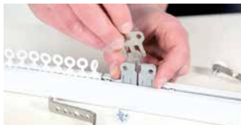
Étape 5 : On insert la plaque de fixation qui raccorde les 2 demi-conducteurs.
